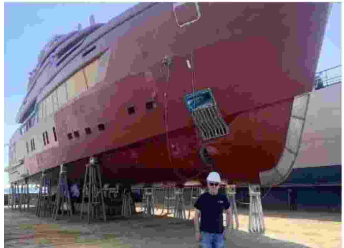
Il superyacht di 44 metri con scafo e sovrastruttura in alluminio, costruito dalla Gestione Bacini spa su commissione del Cantiere Sanlorenzo
